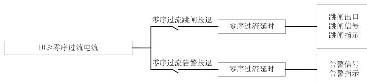
另外零序过流 3 段还可以选择反时限动作，同样提供满足国际电工委员会(IEC255-4)规定的 3 种反时限特性供用户选择。
